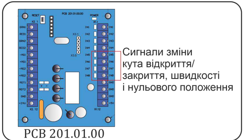
Рис. 19 – Сигнали зміни кута повороту на контролері PCB 201
