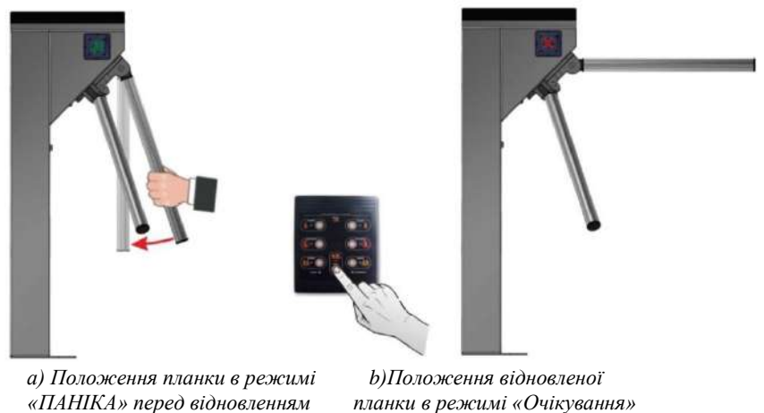
Рис.8 – Деактивація режиму «ПАНІКА» і відновлення планки у вихідне положення
