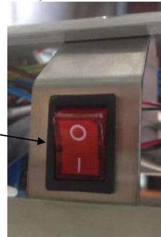
б) кнопка вкл/выкл питания 220 V
