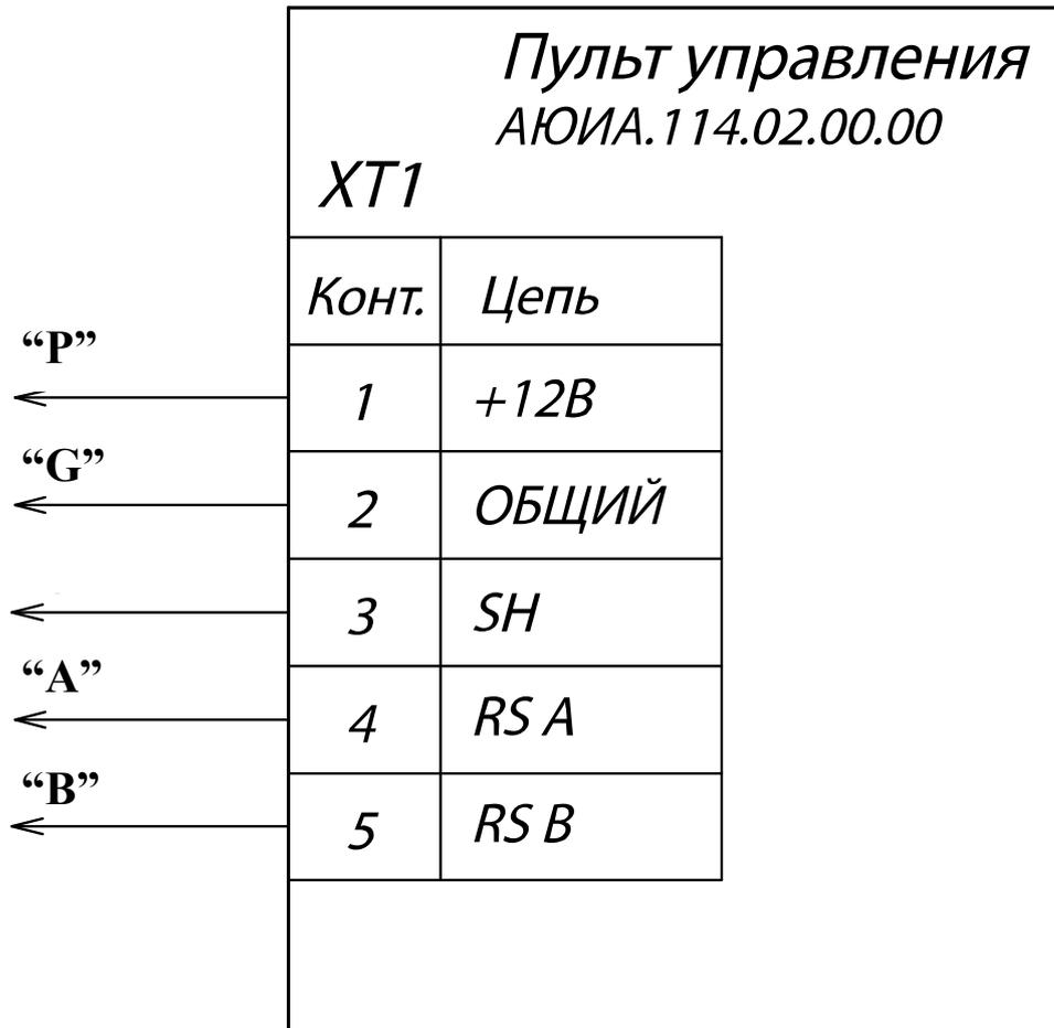
Рисунок Б.2 – Схема электрическая подключения пульта управления
