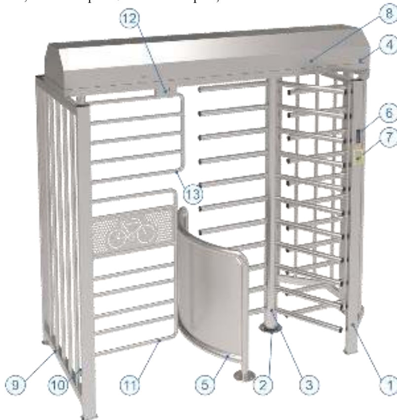
Рис. 2 – Конструкція та загальний вигляд серії однопрохідних турнікетів з хврткою «BICYCLONE-L»
