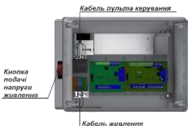
Рис.14– Блок електронного керування – підключення турнікету
