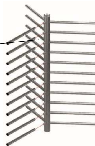
Рис.10– Складання основних елементів та встановлення планок турнікету
