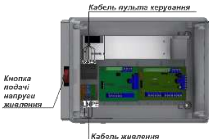
Рис.15– Блок електронного керування – підключення турнікету
