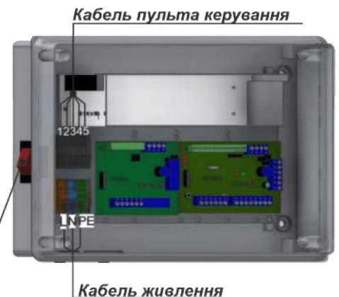
Рис.15– Блок електронного керування – підключення турнікету
