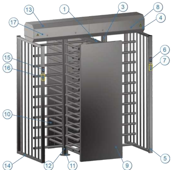
Рис. 2 – Конструкція та загальний вигляд серії двопрхідних турнікетів «SESAME-A TWIN»
